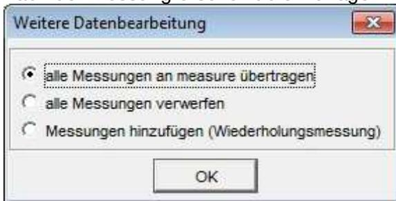
Markieren Sie den ersten Punkt und bestätigen Sie mit OK. Die Messwerte werden nun direkt an die Software measure übertragen. Am Ende dieser Versuchsanleitung ist eine kurze Einführung in die Auswertung der erhaltenen Spektren angefügt.
