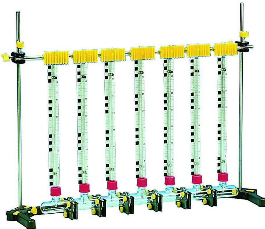
Рис. 1. Установка с 7 камерами для количественных осмотических экспериментов
