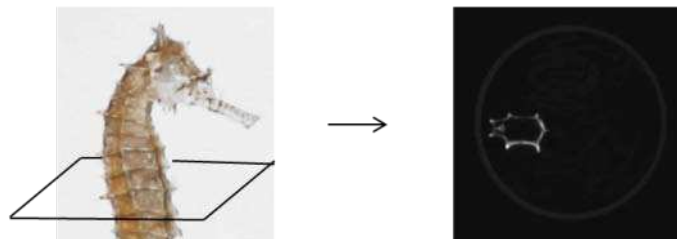
Abb. 10: Prinzip einer CT-Aufnahme
