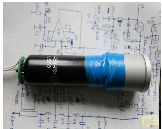
Рис 2.2. Рабочая сборка ФЭУ-сцинтиллятор.
