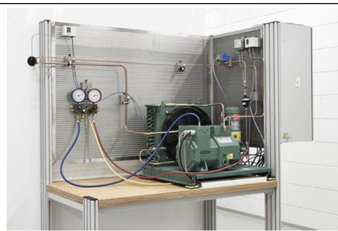
«Строение и монтаж холодильных систем»(RCW1)
