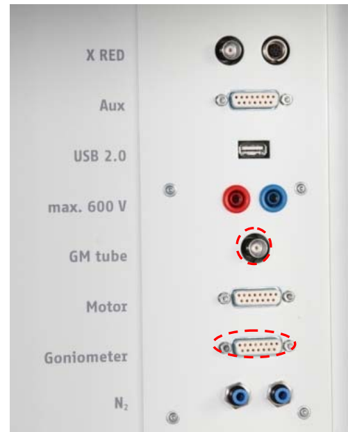
Abb. 2: Anschlüsse im Experimentierraum
