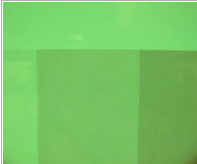
Abb. 2: Plexiglas, von links nach rechts: d = 1\text{ mm} , 5\text{ mm} , and 10\text{ mm} (oben: kein Absorber)
