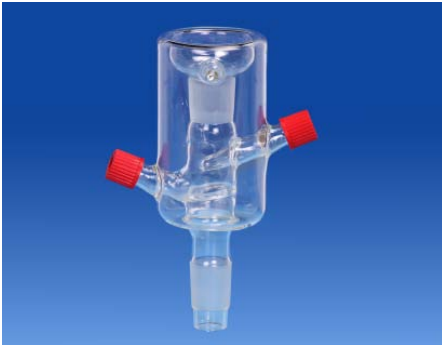
Abb. 8: Kolonnenzwischenstück mit Probennehmer (links) und Hülse für einen Temperatursensor (rechts)
